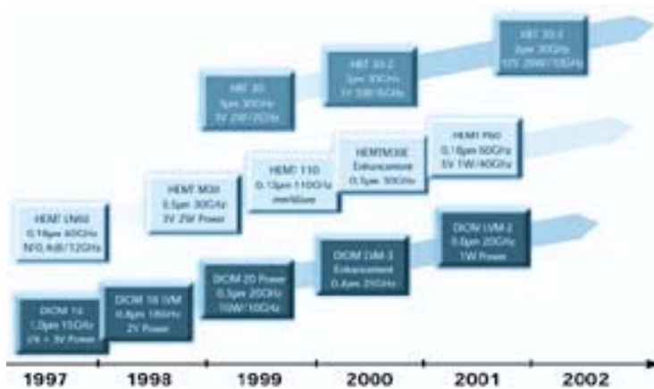
Рис. 1. Развитие направлений технологии GaAs фирмы Infineon Technologies
