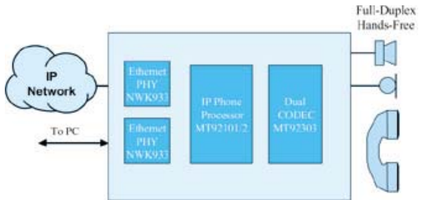
Рис. 1. Структурная схема офисного IP-телефона
